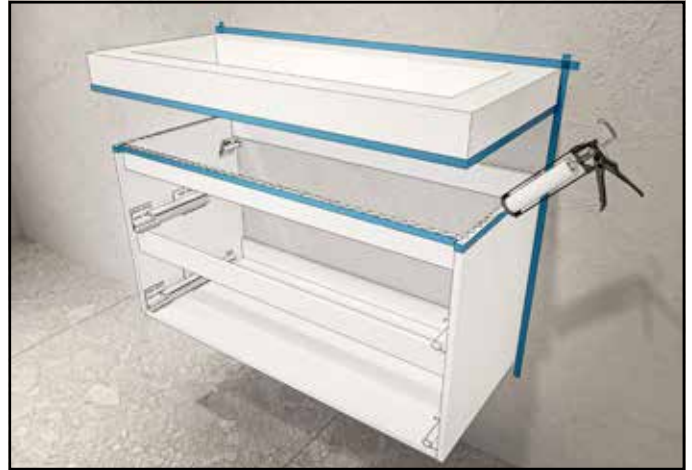
Afkitten tussen wastafel en onderkast
